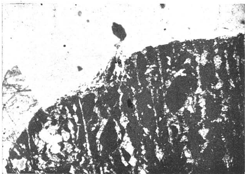
Obr. 1. Prerastanie šelitu (sivý) s ferberitom (čierny) v žilnom kremeni (biely). II nikoly, zv. 140 \times . Foto Kantor.
